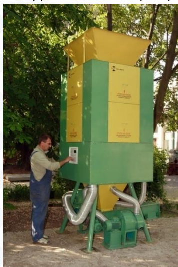
СВЧ – сушилка АСТ Стоимость 1700000 руб Производительность 0,2-1 т/ч
