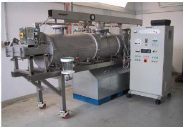
СВЧ – вакуумная сушилка фирмы MIVAR Стоимость 1155000 руб Производительность 0,1-0,3 т/ч
