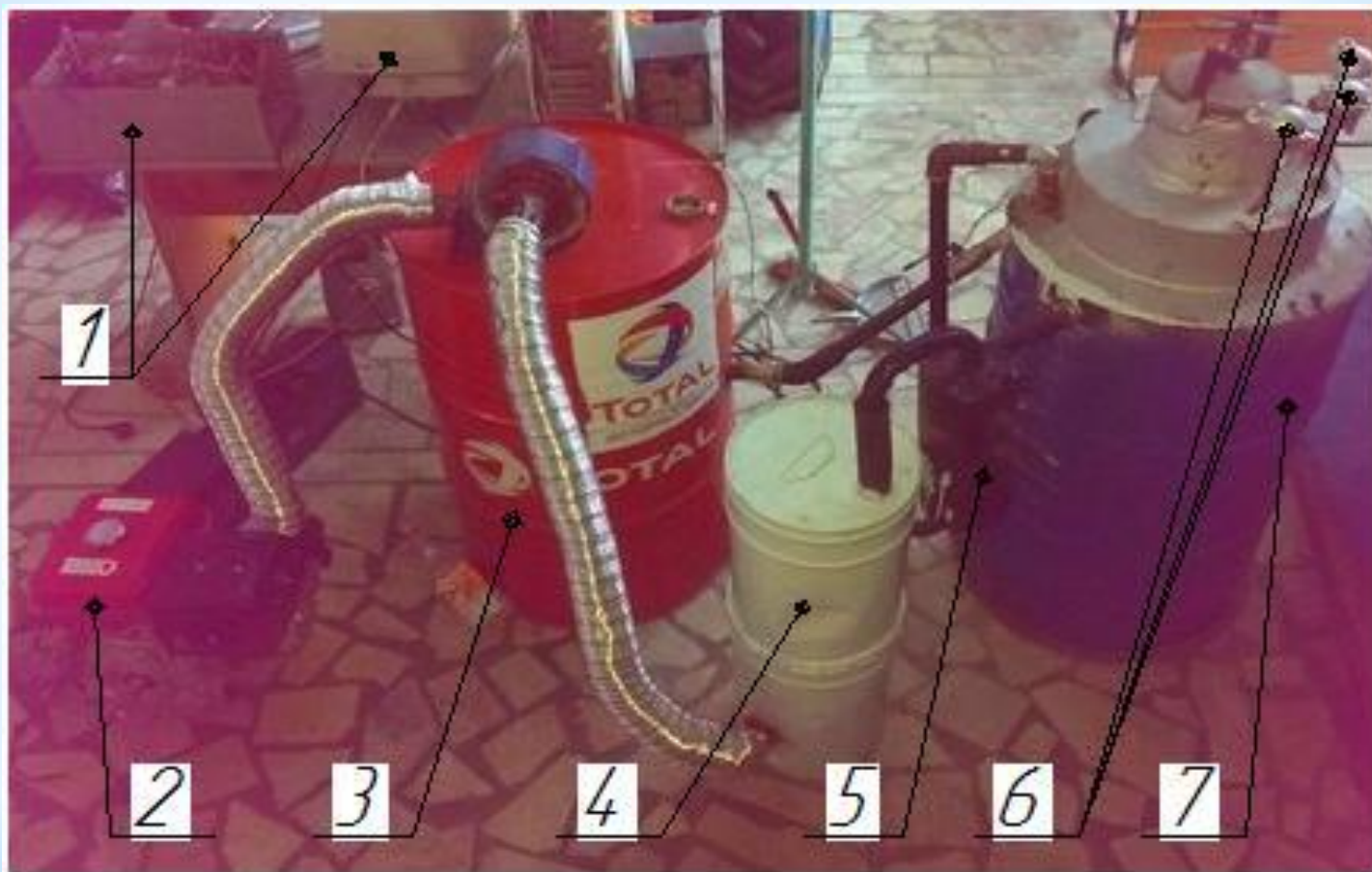
Рисунок 2. Экспериментальный энергетический комплекс с газогенераторной установкой
