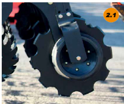
Рис. 3. Устройство Strip-till-культиватора: 2.1 – передний режущий диск; 2.2 – очистители ряда; 2.3 – рыхлительная стойка; 2.4 – боковые диски; 2.5 – прикатывающий каток.
