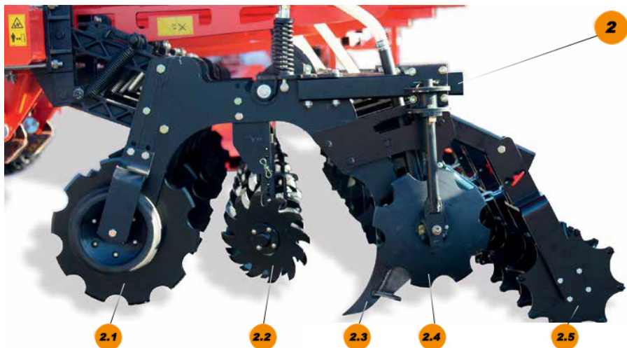
Рис. 3. Устройство Strip-till-культиватора: 2.1 – передний режущий диск; 2.2 – очистители ряда; 2.3 – рыхлительная стойка; 2.4 – боковые диски; 2.5 – прикатывающий каток.
